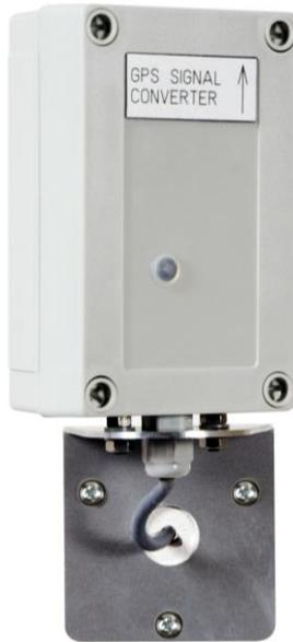
L'antenne GPS combine une antenne plane et un convertisseur de fréquence, qui convertit le signal à étalement de spectre haute fréquence modulé en phase du système GPS en une fréquence intermédiaire. Un câble standard (par exemple AWG22) peut ainsi être utilisé pour la connexion avec l'horloge GPS. Possibilité d'une distance jusqu'à 120 mètres entre le récepteur et l'antenne sans amplificateur supplémentaire.
